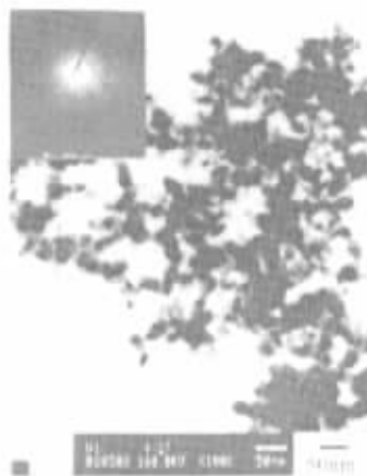
图 2 超微镍粒子分散溶液(约 5%)的 TEM 照片 Fig. 2 TEM images of the ultrafine nickle particles
