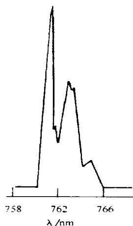
图 2 镍表面催化方法得到的 O_2(b^1\Sigma_g^+ \rightarrow X^3\Sigma_g^+) 的(0,0)电子振动跃迁光谱
