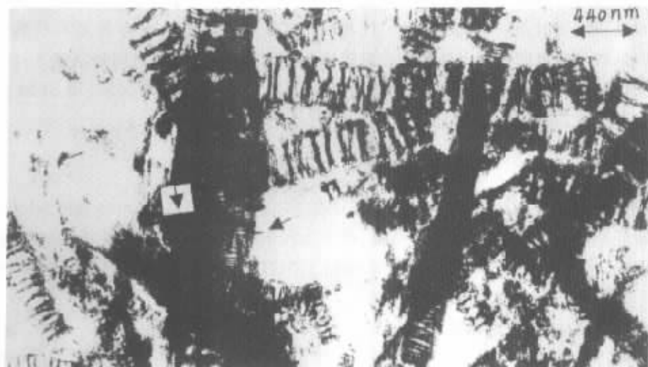
图 3 在 600 °C 和 C_2H_2 流量 6 mL/min 条件下生长的高产率节状碳纤维的 TEM 镜像图
